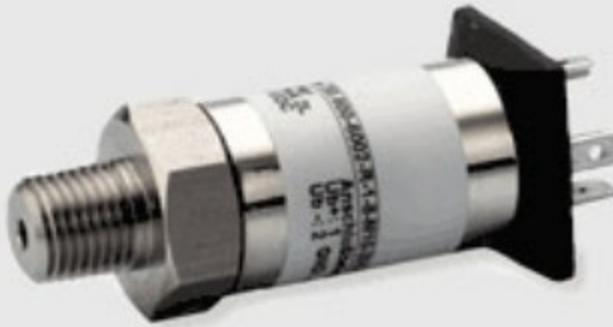
Экономичный датчик давления DMP 330M был специально разработан для применения в сфере жилищно-коммунального хозяйства, в системах где требуются надёжные датчики, устойчивые к высоким перегрузкам и гидроударам. Датчик обеспечивает пропорциональное преобразование давления рабочей среды в электрический сигнал 4...20 мА с погрешностью 1% от диапазона измерения. Корпус датчика изготовлен из нержавеющей стали.
